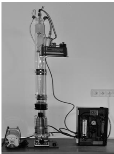
Obr. 5: Zkoušení účinnosti bakteriální filtrace
