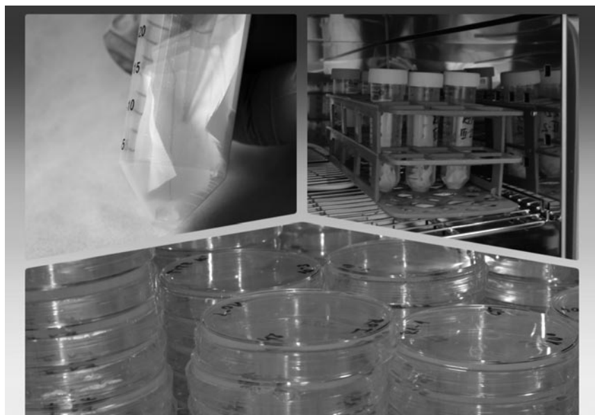
Obr. 2: Testování antimikrobiální aktivity textilních materiálů – testovací agens (bakteriální buňky nebo virové částice) je naneseno na čtverečky sterilní textilie, po inkubaci v dané teplotě je vytřepáno do vhodného média a kultivováno tak, aby mohl být stanoven počet buněk/ částic přeživších na textilním materiálu s antimikrobiální úpravou.
