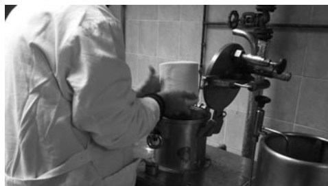
Schéma postupu značení PES příze na cirkulačním aparátu Obermaier (INOTEX)
