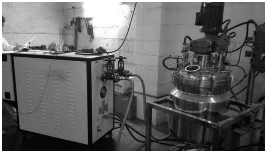
Poloprovozní zařízení pro syntézu bio-polyuretanů s kapacitou 65 kg (COLOR- CENTER).
