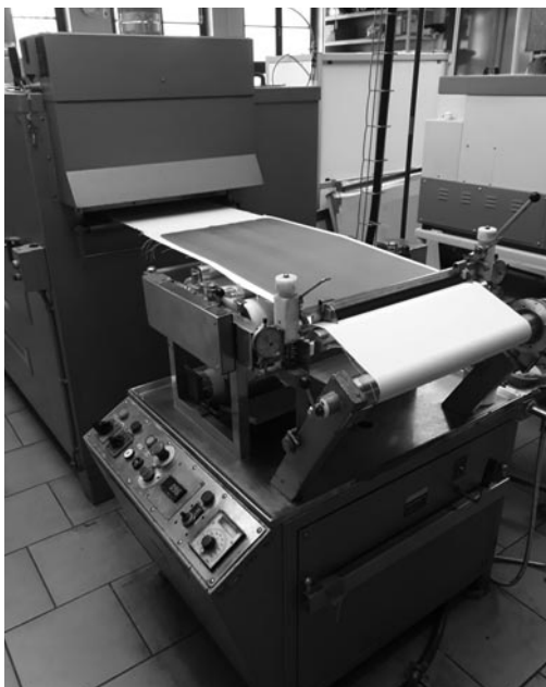
Poloprovozní optimalizace vodonepropustného bio-PU zátěru s antistatickým efektem 3294_IPDI_2 SWCNT 0.1% (INOTEX).
