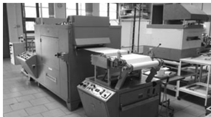
R2R konti pilotní linka Werner-Mathis v impregnačním (vlevo) a zátěrovém (vpravo) režimu (technol. lab INOTEX).
